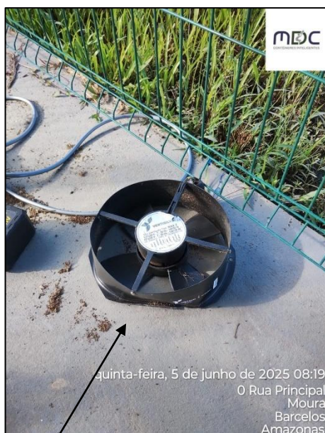
Eletro ventilador com defeito
